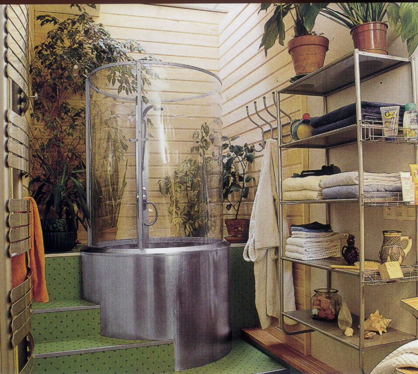
Choisi en rouleau, un revêtement vinyle permet d'habiller le sol en limitant le plus possible les risques d'infiltration. © Photo Ph. Louzon.
