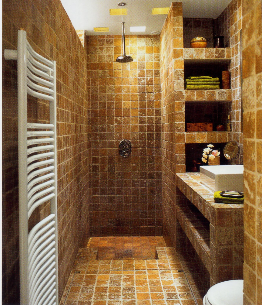
Inscrite entre des parois maçonnées et habillées de carreaux en marbre, la douche sur mesure bénéficie d'un receveur préformé carrelé. © Architecte T. Le Guay. Photo A. Duarte.
