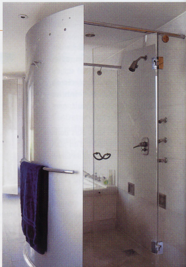
Inscrite entre des parois maçonnées et habillées de carreaux en marbre, la douche sur mesure bénéficie d'un receveur préformé carrelé. © Architecte T. Le Guay. Photo A. Duarte.
